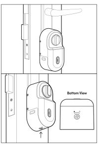
(EN) Install the battery cover and turn the screw to the 'locked' position. (DE) Bringen Sie die Batterieabdeckung an und drehen Sie die Schraube in die "verriegelte" Position. (FR) Placez le couvercle de la batterie et tournez la vis de manière à ce qu'elle soit solidement fixée. (IT) Installare il coperchio della batteria e girare la vite in posizione "bloccata". (ES) Instale la tapa de las pilas y gire el tornillo a la posición de «bloqueado».
