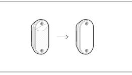
(EN) Peel off the backing of the adhesive found on the back of the door sensor. (DE) Entfernen Sie die Schutzfolie der Klebefläche auf der Rückseite des Türsensors. (FR) Décollez le dos de l'adhésif qui se trouve au dos du capteur de porte. (IT) Staccare la parte posteriore dell'adesivo che si trova sul retro del sensore della porta. (ES) Despegue el reverso del adhesivo que se encuentra en la parte posterior del sensor de la puerta.
