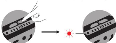
Clique no botão curto para alternar entre Tensão 12V/16,5V/20V/24V.
